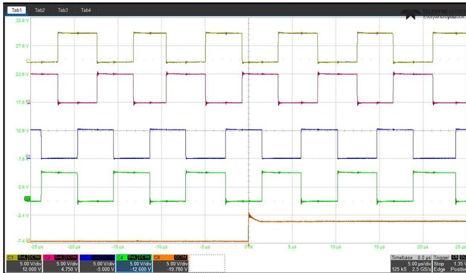
Abbildung 5 Inkrementalsignale ENX 22 MILE
