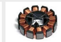
Kürzere Motoren mit mehrpoliger Bauweise für hohe Drehmomente verwenden Wicklungen mit Eisenkern, wie die Programme ECX TORQUE, EC-i und EC flat. Die zusätzlichen Eisenverluste im Kern begrenzen die maximale Drehzahl dieser Motoren.
