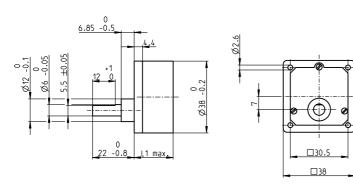
**テクニカルデータ**スパーギアヘッド 直線歯 ステンレススチール 出力軸受け 焼結スリーブベアリング 最大 0.1 mm の点 30 N 最大スラスト荷重 (ダイナミック) 最大連続入力回転数 5000 rpm 使用温度範囲 1 2 3 4 5 最大ラジアル荷重、フランジから12 mmの点 50 N 50 N 50 N 50 N 50 N 50 N 50 N
