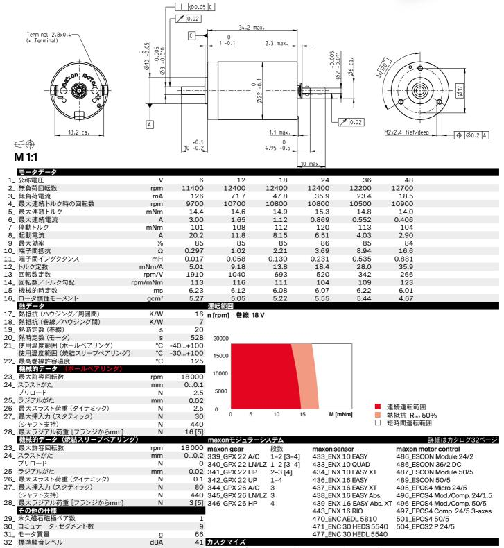
ベアリング:プリロードされたボールベアリング/焼結スリーブベアリング整流:貴金属ブラシCLL付きまたはCLLなし/グラファイトブラシ/EMIフィルタフランジ前部/後部:標準フランジ/カスタマイズ可能フランジ/フランジなしシャフト前部/後部:長さ/直径/フラット電気接続:端子またはケーブル/接続方向/ケーブル長/コネクタのタイプ
