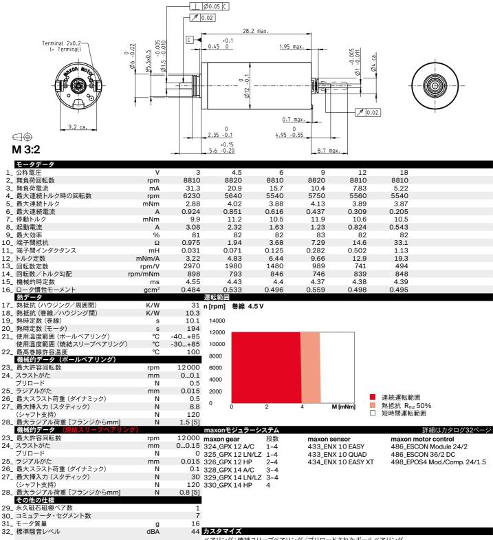
\_\_\_\_\_\_\_\_\_\_\_ ベアリング:焼結スリーブベアリング/プリロードされたボールベアリング 整流: 貴金属ブラシCLL付きまたはCLLなし
