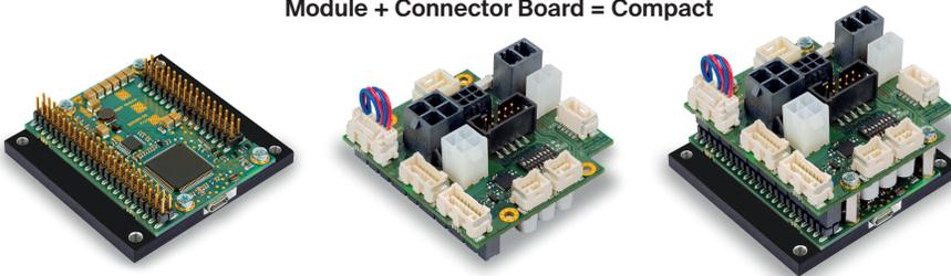
EPOS4 ist eine modular aufgebaute digitale Positioniersteuerung. Sie eignet sich für permanentere Gleichstrommotoren (DC) und bürstenlose, elektronisch kommutierte Gleichstrommotoren (EC) mit Inkremental- oder Absolut-
