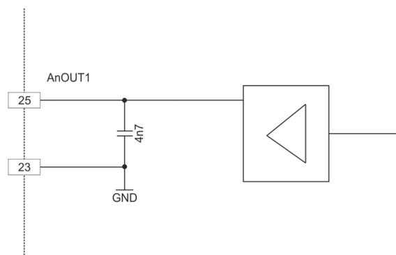
Figura 3-16 Circuito AnOUT1 (applicabile anche per AnOUT2)
