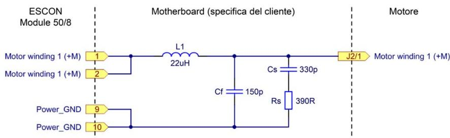
Figura 5-26 Circuito dell'avvolgimento del motore 1 (applicabile anche per gli avvolgimenti del motore 2 e 3)
