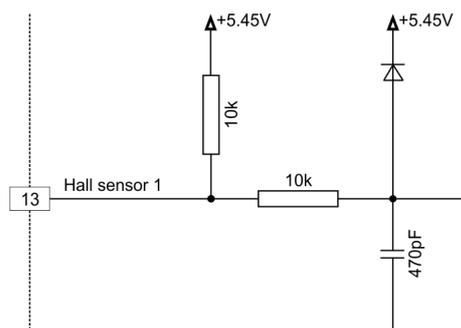
Figura 3-7 Circuito di ingresso sensore Hall 1 (applicabile anche per sensori Hall 2 e 3)
