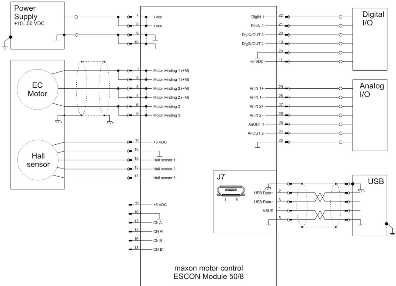
Figura 4-23 maxon EC motor con sensori Hall
