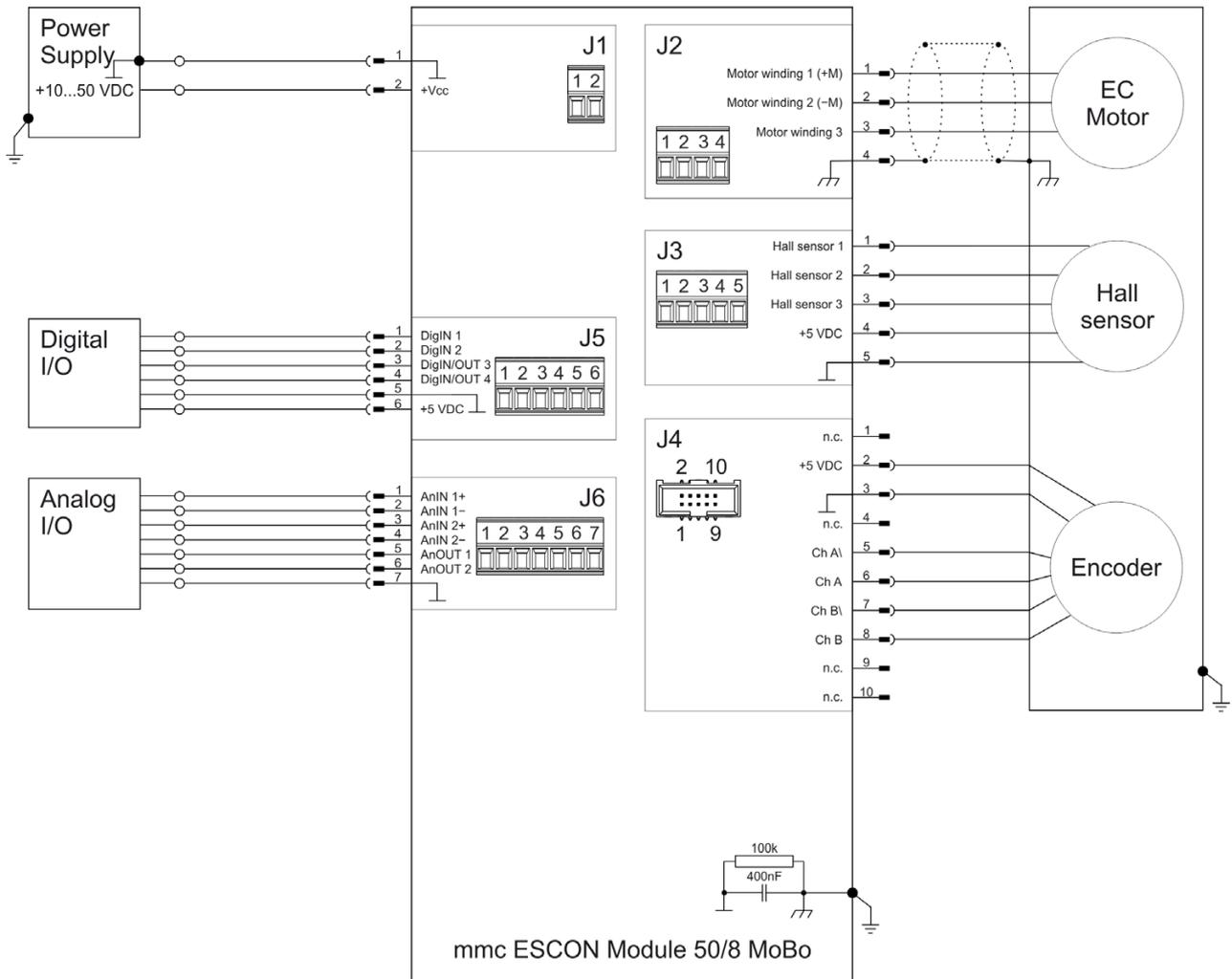
Figura 5-41 ESCON Module 50/8 MoBo – maxon EC motor con sensori Hall ed encoder (J2 / J3 / J4)
