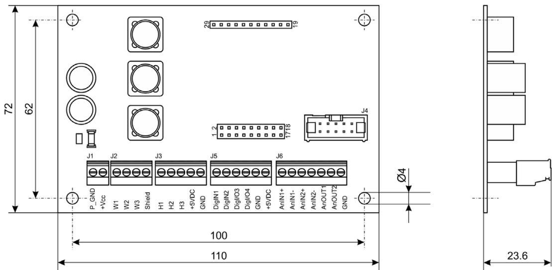
Figura 5-29 ESCON Module 50/8 MoBo – Disegno quotato [mm]
