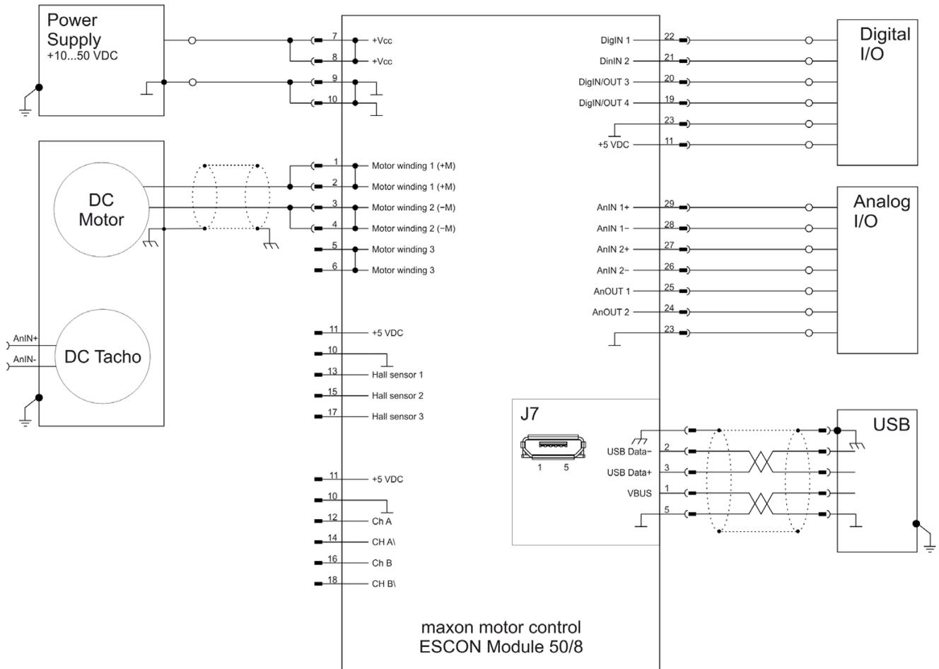
Figura 4-21 maxon DC motor con dinamo tachimetrica DC
