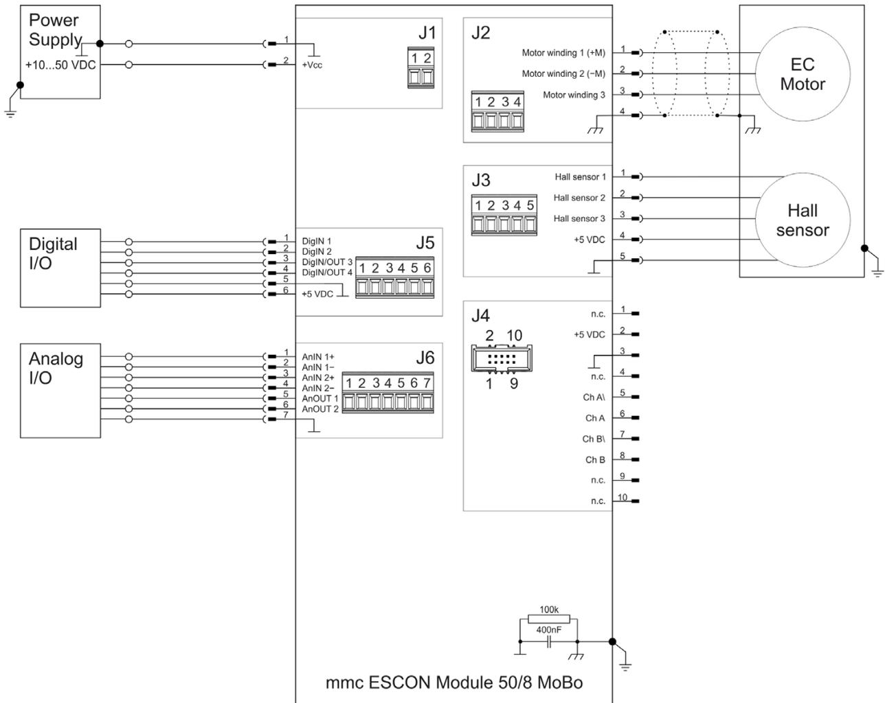
Figura 5-40 ESCON Module 50/8 MoBo – maxon EC motor con sensori Hall (J2 / J3)
