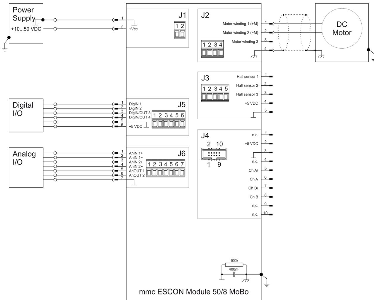
Figura 5-37 ESCON Module 50/8 MoBo – maxon DC motor (J2)
