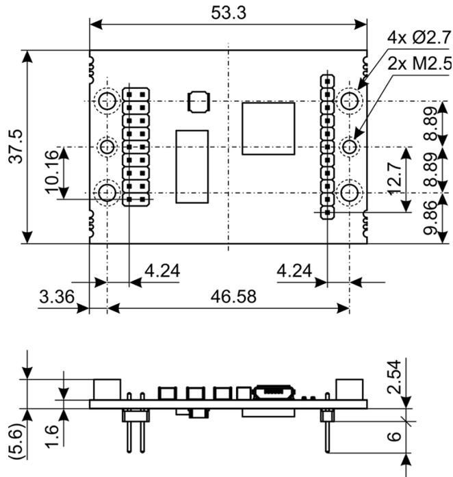
Figura 2-3 ESCON Module 50/8 – Disegno quotato [mm]
