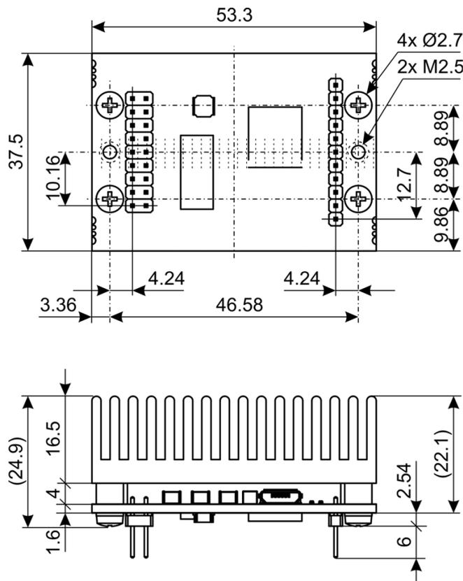
Figura 2-4 ESCON Module 50/8 HE – Disegno quotato [mm]
