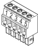
Abbildung 5-33 ESCON Module 50/8 MoBo – Hall-Sensor Stecker J3
