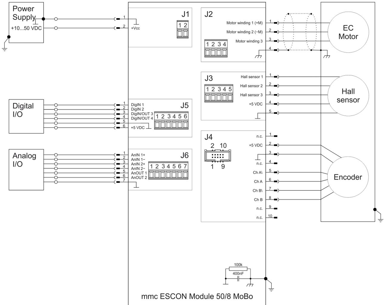
Abbildung 5-41 ESCON Module 50/8 MoBo – maxon EC motor mit Hall-Sensoren & Encoder (J2 / J3 / J4)
