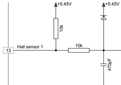
Abbildung 3-7 Hall-Sensor 1 Eingangsbeschaltung (sinngemäss auch für Hall-Sensoren 2 &amp; 3)
