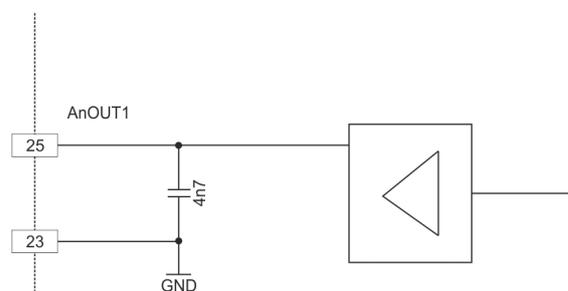
Abbildung 3-16 AnOUT1 Schaltung (sinngemäss auch für AnOUT2)
