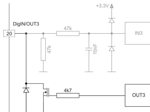
Abbildung 3-13 DigOUT3 Schaltung (sinngemäss auch für DigOUT4)
