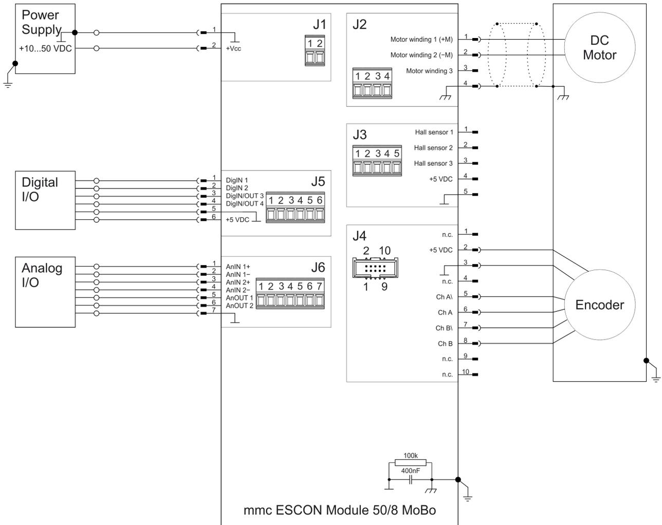
Abbildung 5-39 ESCON Module 50/8 MoBo – maxon DC motor mit Encoder (J2 / J4)
