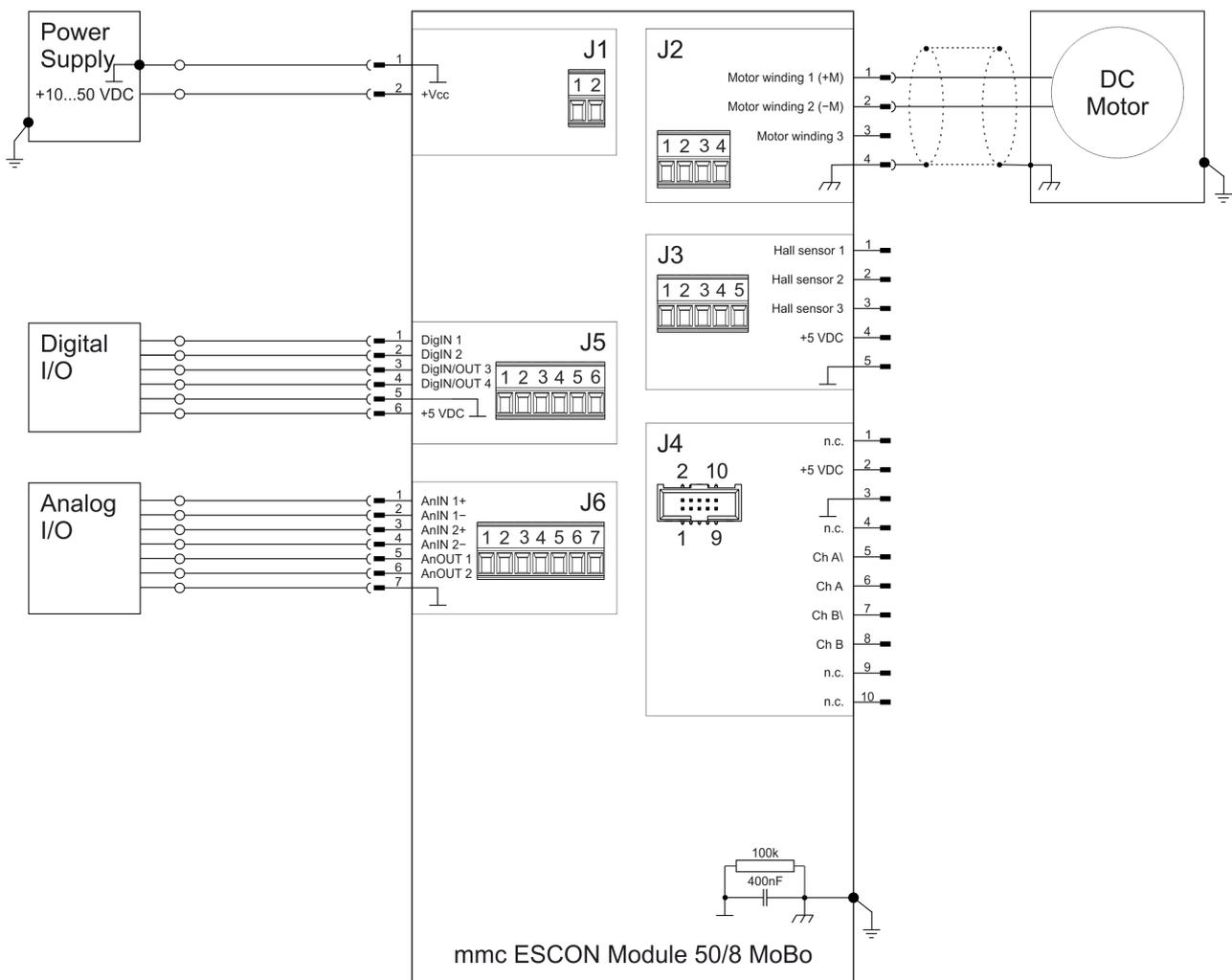
Abbildung 5-37 ESCON Module 50/8 MoBo – maxon DC motor (J2)
