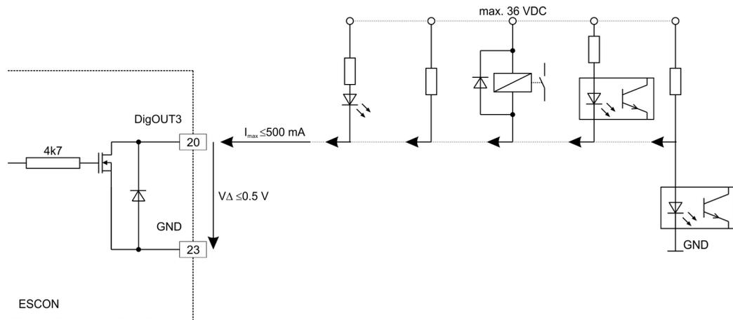
Abbildung 3-14 DigOUT3 Schaltungsbeispiele (sinngemäss auch für DigOUT4)
