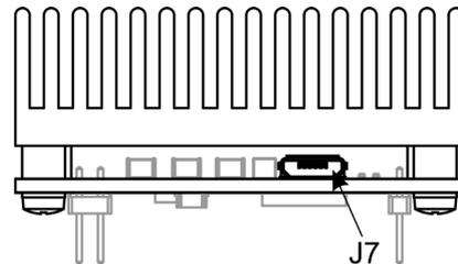
Abbildung 4-19 Schnittstellen – Bezeichnungen und Einbauort
