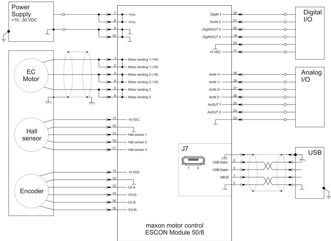
Abbildung 4-24 maxon EC motor mit Hall-Sensoren & Encoder
