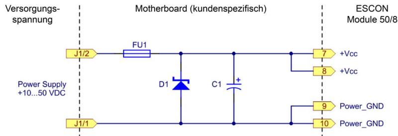
Abbildung 5-25 Beschaltung Versorgungsspannungsleitung
