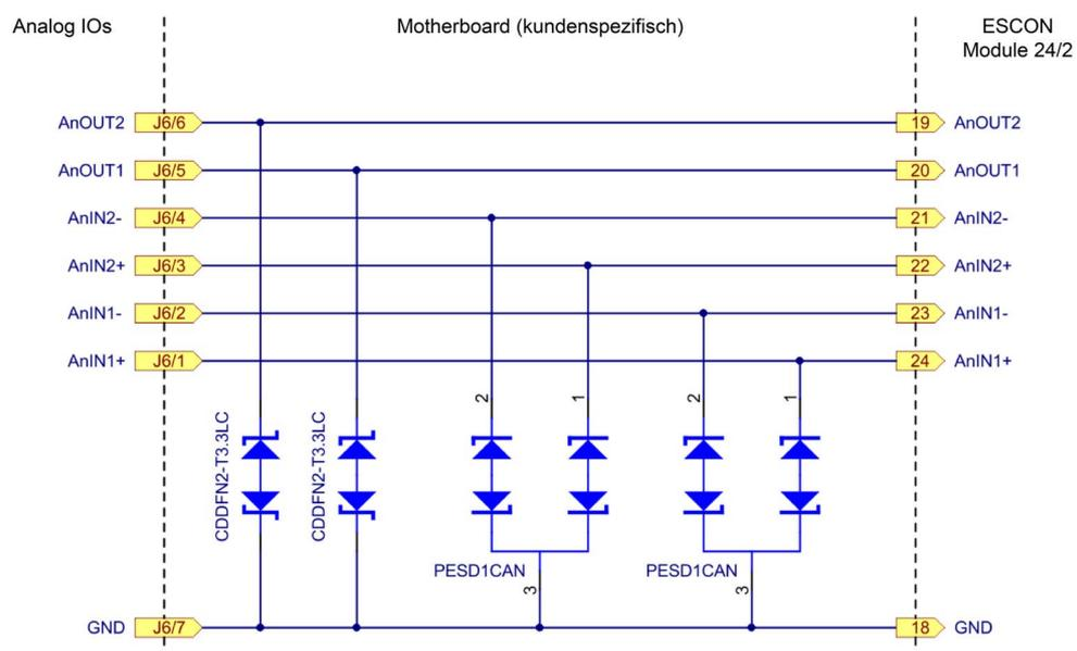
Abbildung 5-25 Analoge Ein- und Ausgänge – Schutzbeschlaltung
