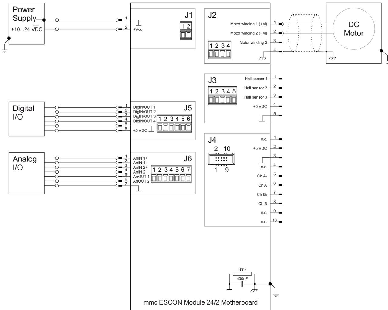
Abbildung 5-37 ESCON Module MoBo – maxon DC motor (J2)
