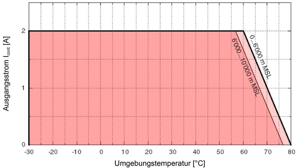
Abbildung 2-1 Derating Ausgangsstrom
