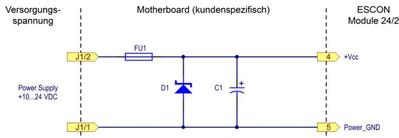
Abbildung 5-23 Beschaltung Versorgungsspannungsleitung
