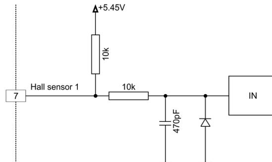
Abbildung 3-5 Hall-Sensor 1 Eingangsbeschaltung (sinngemäss auch für Hall-Sensoren 2 &amp; 3)
