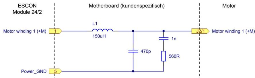
Abbildung 5-26 Beschaltung Motorwicklung 1 (sinngemäß auch für Motorwicklung 2 & 3)
