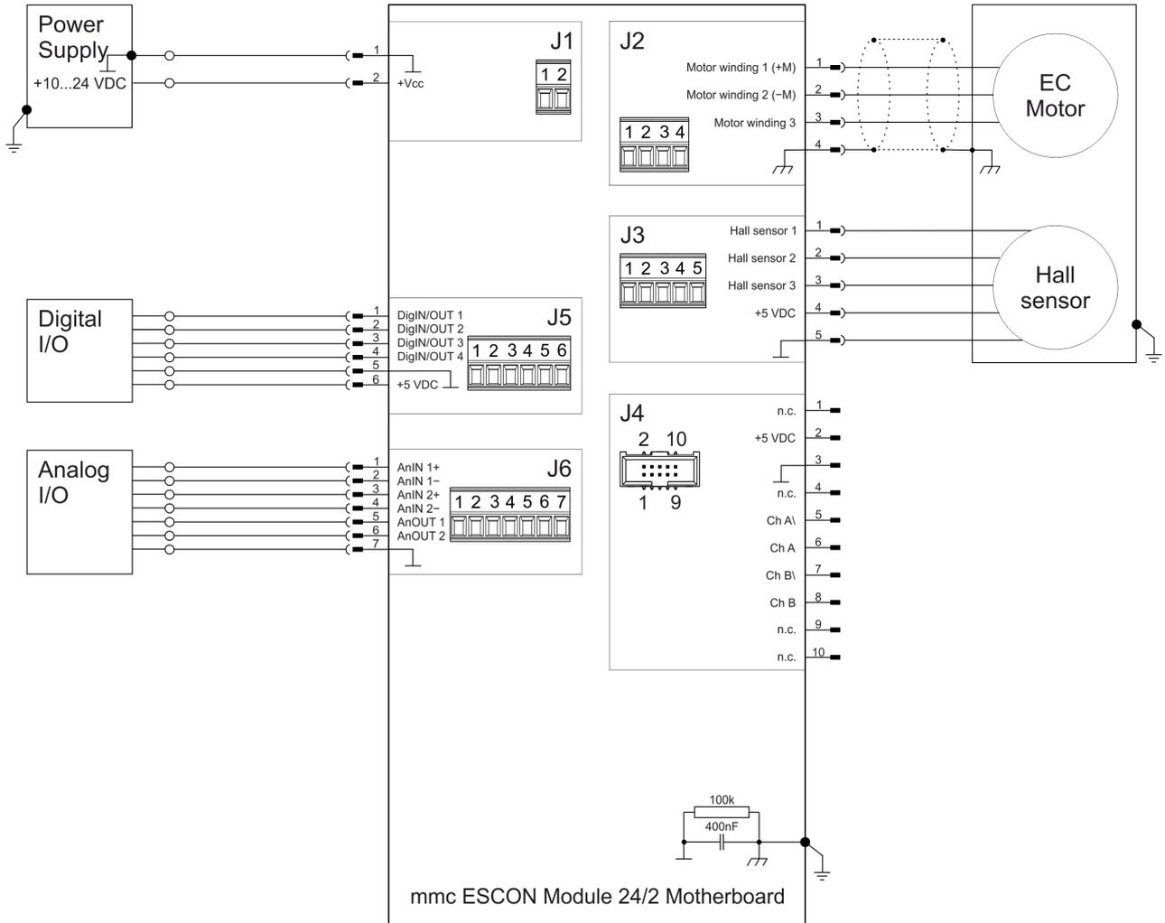
Abbildung 5-40 ESCON Module MoBo – maxon EC motor mit Hall-Sensoren (J2 / J3)
