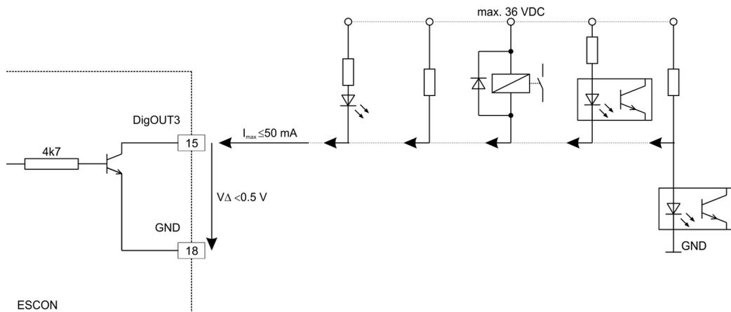
Abbildung 3-12 DigOUT3 Schaltungsbeispiele (sinngemäss auch für DigOUT4)
