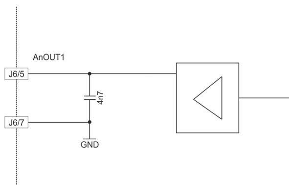
Figura 3-18 Circuito AnOUT1 (applicabile anche per AnOUT2)
