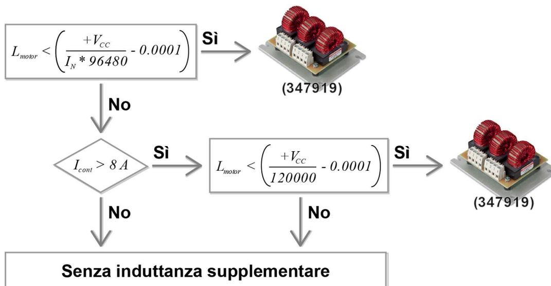
$L_{motor}[H]$  Induttanza ai terminali del motore (→linea 11 nel catalogo maxon)
