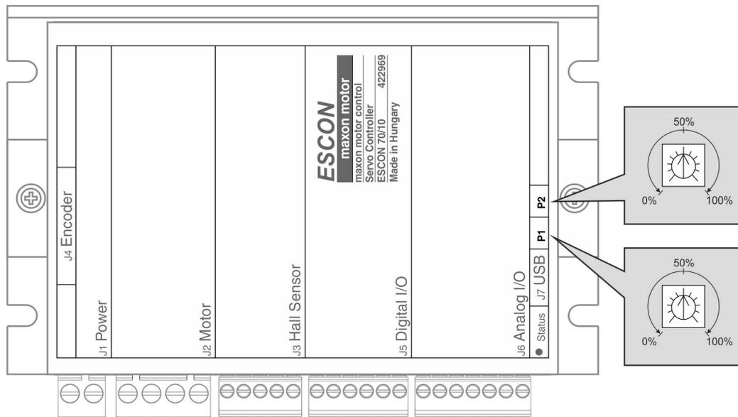
Figura 3-20 Potenziometri – Posizione di montaggio e campo di regolazione
