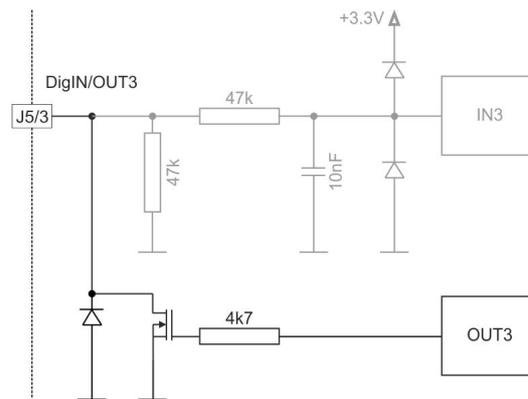
Figura 3-14 Circuito DigOUT3 (applicabile anche per DigOUT4)
