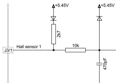
Figura 3-6 Circuito di ingresso sensore Hall 1 (applicabile anche per sensori Hall 2 e 3)
