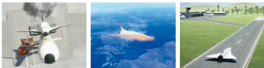
Raketentriebwerke sorgen für Höchstgeschwindigkeiten: Nach dem ersten Antriebsschub trennt sich die Boosterstufe von der Passagierkapsel. Gelandet wird wie bei einem Passagierflugzeug.
