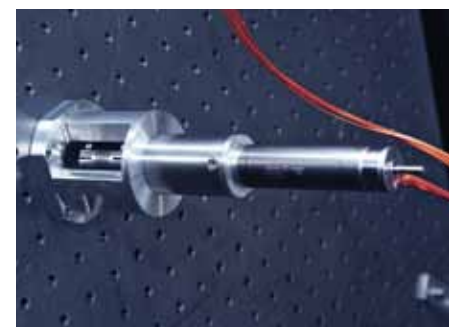
Der modifizierte maxon Motor EC 22 HD im Teilchenbeschleuniger DLS.
