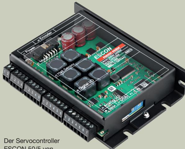
Der Servocontroller ESCON 50/5 von maxon motor.
