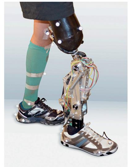
**Knieprothese:** Wenn richtig grosse Leistungen gefragt sind, wie bei der Knieprothese der ETH, kommt der EC-4pole 30 zum Einsatz. Dank seiner zwei Polpaare erreicht er eine extrem hohe Leistungsdichte und ein beachtliches Nenn Drehmoment. Zudem ist der Motor hart im Nehmen, er darf kurzzeitig überlastet werden.
