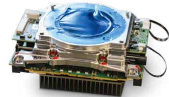
Die AMIRA-Sensor-Baugruppe mit ND-Filterschieber. Einer der beiden RE 8-Motoren ist rechts unten zu erkennen.
