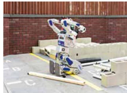
Bei der Darpa Robotics Challenge müssen sich Katastrophenroboter in vielen Disziplinen beweisen, indem sie u.a. Auto fahren, Ventile betätigen und schwieriges Terrain überwinden.
