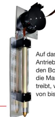
Auf das maxon Antriebssystem, das den Bolzen HP<sup>3</sup> in die Marsoberfläche treibt, wirken Kräfte von bis zu 400 g.
