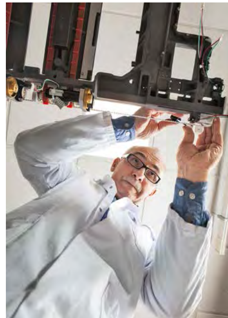
Thierry Bournier stellt die Spannung des Riemens ein.
