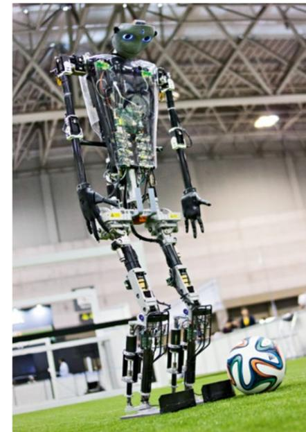
Der Roboter mit den hellblauen Augen und den übergrossen Füßen lief vollkommen autonom auf dem Spielfeld. Sweaty orientierte sich allein über die im Kopf verbaute Kamera. Bei der «Technical Challenge» hatte der Roboter in der Disziplin «Goal-Kick from Rolling Ball» am besten abgeschnitten. Kein anderer Roboter konnte so präzise wie er den rollenden Ball erkennen und zuverlässig ins Tor schießen.
