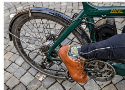
Der maxon Bikedrive-Heckmotor wiegt nur drei Kilogramm. Er lässt sich in praktisch jedes Fahrrad einbauen – auch in Lastbikes.
