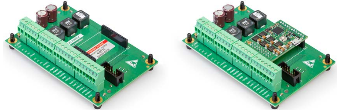
Illustration 5-26 ESCON Module MoBo (à gauche) avec ESCON Module 50/5 mis en place (à droite)
