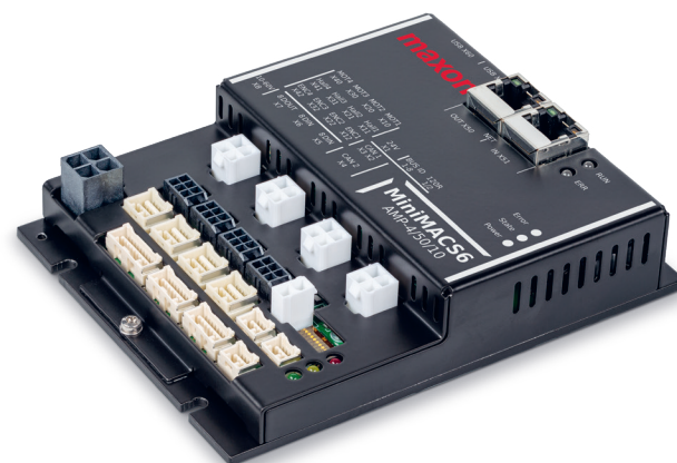
Motion Controller: Wenn mehrere Achsen zusammenspielen, sorgt die übergeordnete Steuerung für koordinierte Bewegungsabläufe. Seite 28
