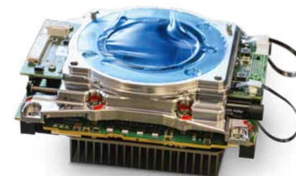
Die AMIRA-Sensor-Baugruppe mit ND-Filterschieber. Einer der beiden RE 8-Motoren ist rechts unten zu erkennen.
