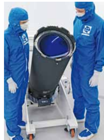
Mit Hilfe der Projektionssysteme OTA werden Lichtpunkte oder «künstliche Sterne» in die Atmosphäre geschossen.
