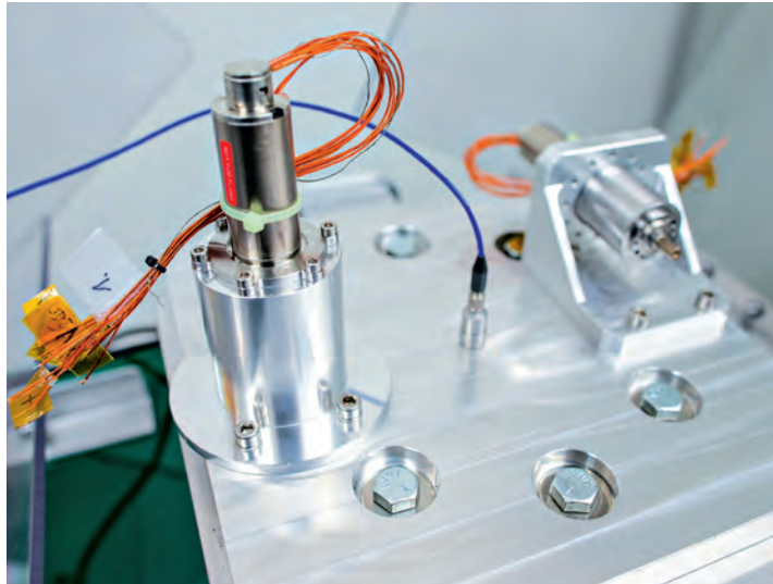
Auf dem mechanischen Schocktester werden die Antriebseinheiten für die Radantriebe des ExoMars-Rovers radial und axial auf ihre Schockresistenz geprüft. Die Anlage erreicht Belastungswerte von 2500 g.
