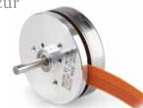
EC 45 flat treibt youBot an Ø 22 mm, bürstenlos, 100 Watt, mit Hall-Sensoren
