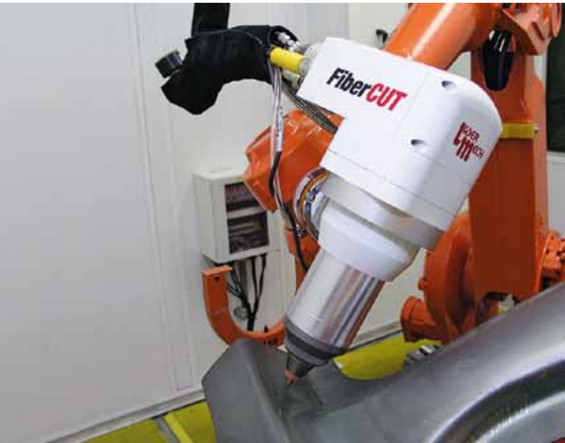
FiberCut-Köpfe werden vor allem in der Autoindustrie eingesetzt, etwa zum Schneiden von Unterbauträgern.
