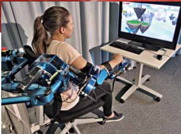
Armroboter: Motoren der RE-Reihe werden sowohl im Armroboter ARMin wie auch in der Kinderversion ChARMin (im Bild) verwendet. Jeder einzelne Motor ist für die Bewegung einer Achse zuständig. Als Beispiel seien hier die beiden RE-40-Antriebe von maxon genannt, welche die zwei Hauptachsen in der Kinderversion antreiben. Dank der patentierten eisenlosen Wicklung und des hochstehenden Magneten erreichen diese Motoren einen Wirkungsgrad von über 90 Prozent.
