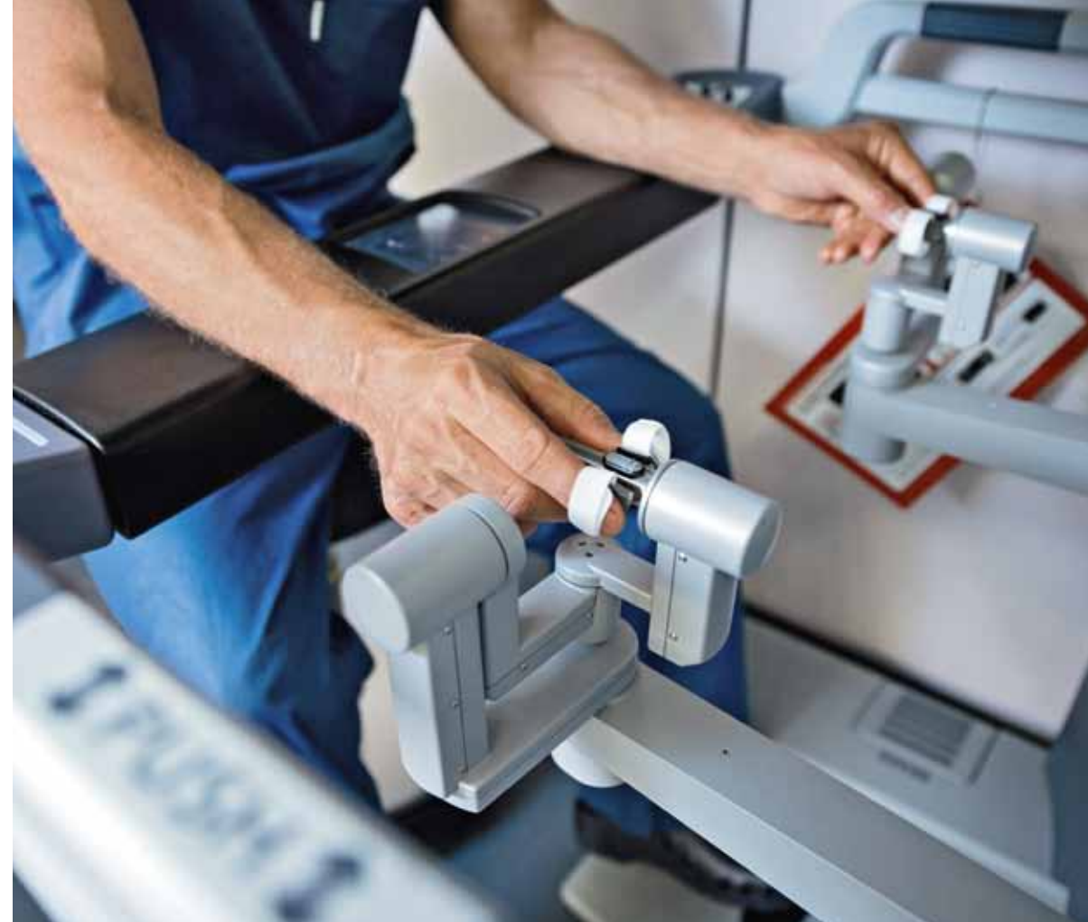
Die Bewegungen des Operationsroboters daVinci steuert der Chirurg manuell über zwei Joysticks.
