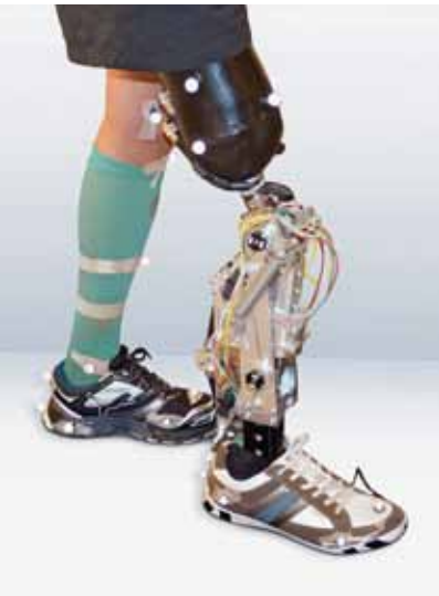
Knieprothese: Wenn richtig grosse Leistungen gefragt sind, wie bei der Knieprothese der ETH, kommt der EC-4pole 30 zum Einsatz. Dank seiner zwei Polpaare erreicht er eine extrem hohe Leistungsdichte und ein beachtliches Nenndrehmoment. Zudem ist der Motor hart im Nehmen, er darf ab und zu kurzzeitig überlastet werden.
