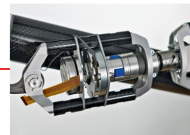
maxon EC 45 flat Ø 45 mm, 30 W, bürstenlos
