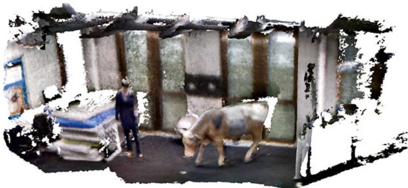
3D-Rekonstruktion der Umgebung durch Flugroboter in Echtzeit, Autonomous Systems Lab, ETH Zürich
