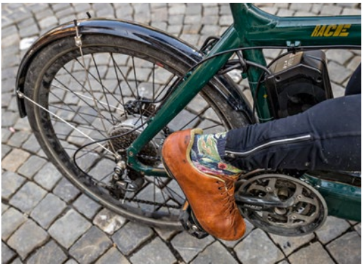
Der maxon Bikedrive-Heckmotor wiegt nur drei Kilogramm. Er lässt sich in praktisch jedes Fahrrad einbauen – auch in Lastbikes.
