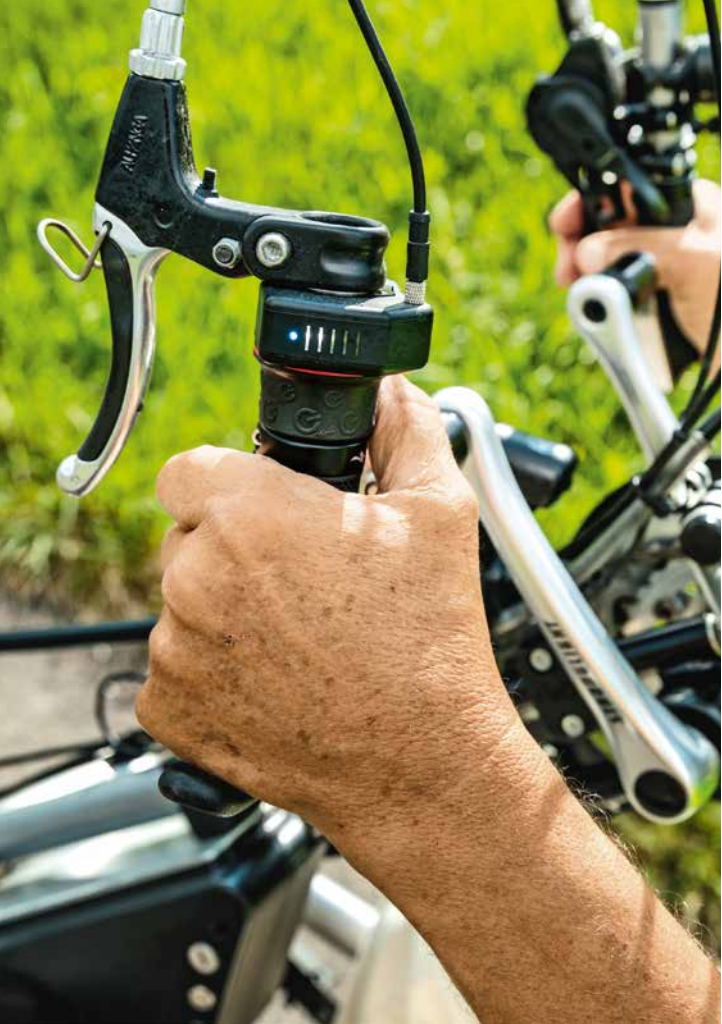
Das Bikedrive-Nachrüstkit aus Motor, Akku und Powergrip passt perfekt ins Handbike von Othmar Zoll. Jetzt meistert er damit sogar steile Zufahrten.
