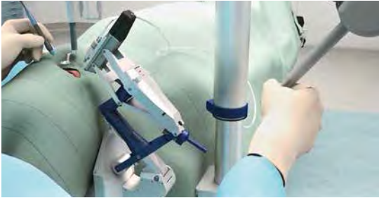
Das neue Robotersystem wird bei der Operation von Netzhauterkrankungen eingesetzt. Ein Joystick sorgt für Präzision: Bewegt der Arzt den Joystick einen Zentimeter, bewegt sich der Roboterarm in der Verlängerung nur einen Millimeter.
