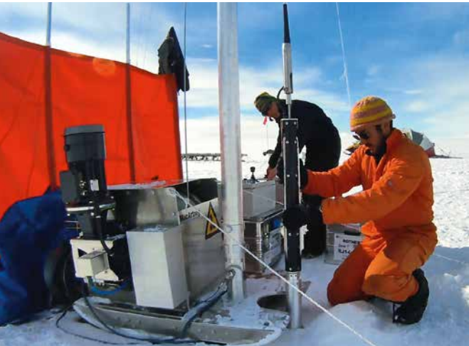
Mit der neuen Technologie ist es möglich, vor grossen Bohrungen mehrere kleine Bohrungen in rund 600 Meter Tiefe zu machen und Eisproben an die Oberfläche zu befördern.
