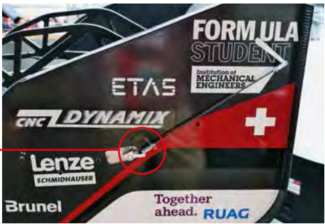
maxon EC 22 Ø 22 mm, 100 W, bürstenlos
