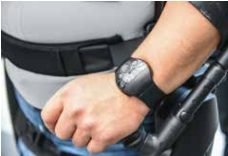
Andre van Rüschen setzt sein Exoskelett mit der Uhr in Bewegung.
