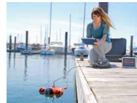
Das ROV HydroView fährt mit 10 Volt Gleichstrom nahezu drei Stunden, je nach Einsatzart. Es kann über iPad oder Laptop gesteuert werden.
