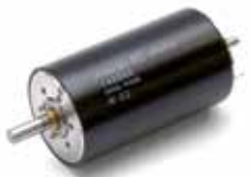
maxon RE 40 Dieser DC-Motor von maxon mit 150 Watt ist mit der bewährten eisenlosen Wicklung und Neodym-Magneten ausgerüstet. Sein Wirkungsgrad liegt dadurch bei über 90 Prozent.
