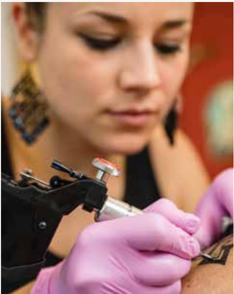
In der weltweit ersten kabellosen Tattoo-Maschine setzt Swisstattoomachine auf den RE 13 Motor von maxon. Der Antrieb besticht durch seine Energieeffizienz und Dynamik.
